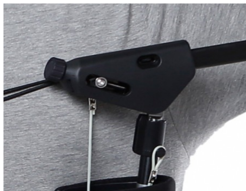
(a) Junta de ligação entre barra do braço e barra de suporte. Extraído de: Industrials (2020)
